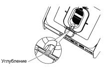
Если крышка датчика сильно загрязнена, снимите крышку датчика и протрите ее тканью, смоченной спиртом. В таком случае соблюдайте осторожность, чтобы отходы припоя или другой мусор не попали внутрь устройства.
